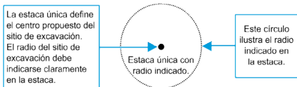
Estaca única que marca el punto central de la excavación
